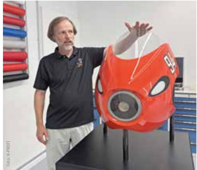
Für diese Motorradmaske erstellte Cirp die Designdaten, konstruierte die Modelle, fertigte die Teile mittels Polyjet-Druck, SLS (Selektives Lasersintern) und Fräsen, lackierte und polierte die Oberflächen und elektrifizierte das Modell.
