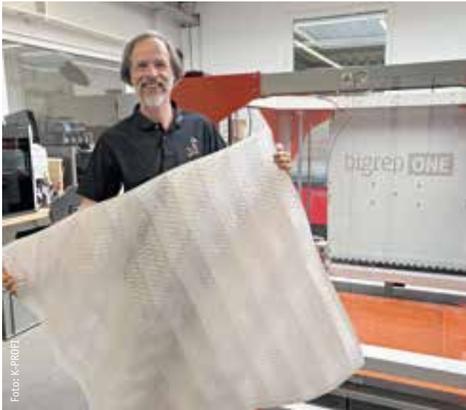
Thomas Lück ist Leiter Vertrieb und Innovation, hier mit PETG-Fassadenverkleidungselementen aus dem Großformat-FDM-Drucker Bigrep One, der ein Bauvolumen von 1.000 x 1.000 x 1.000 mm realisieren kann.
